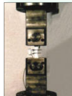
Испытание образца на усталостную прочность
