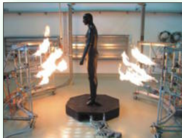
Испытания термостойкого костюма при помощи манекена оборудованного большим количеством термопар
