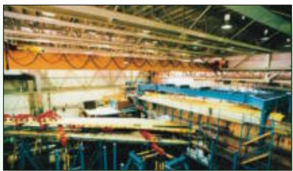
Тензометрическая система для испытания конструкций самолетов
