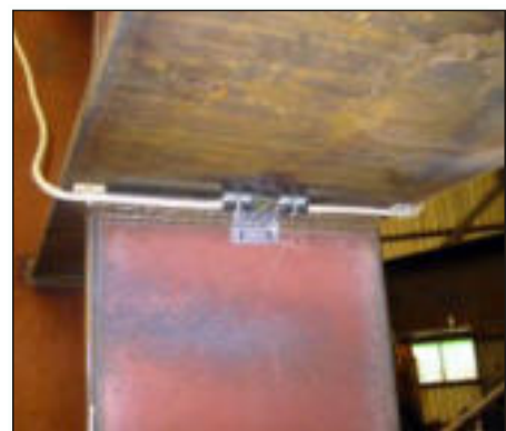
Определение максимальной нагрузки для сварных соединений
